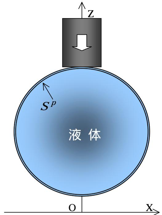
$$f^e = \int_{S^e} -\Phi^T p n dS \quad (5) \quad \text{図4 固体 液体構造体の变形モデル}$$
